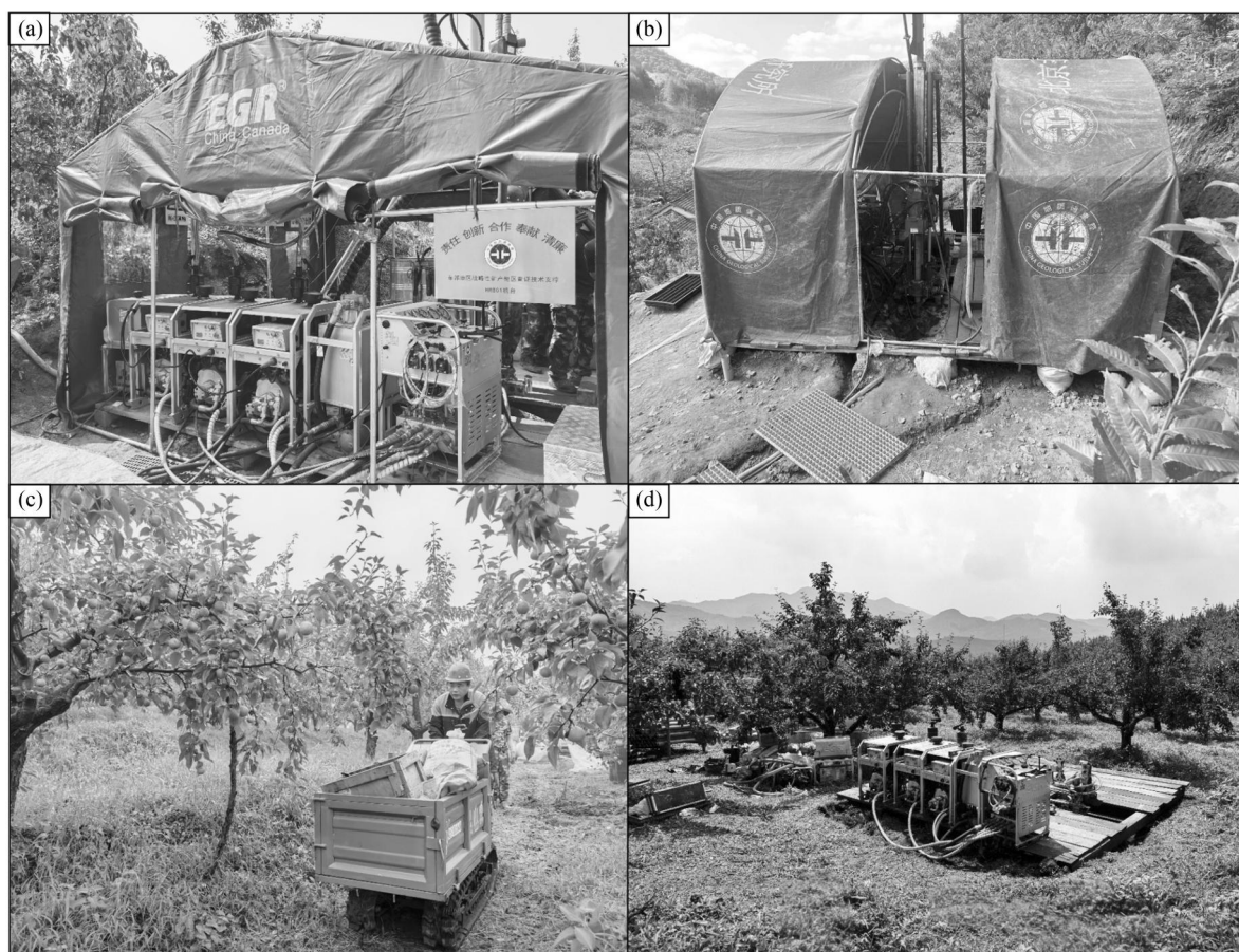
图 2 便携式模块化钻机(a-b)和机台建设(c-d)
